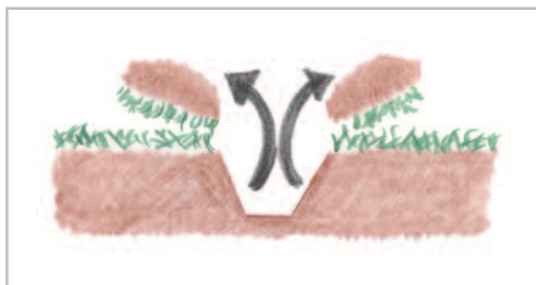
Abb. 36: Anlage eines Grabens mit dem Pflug (Bodenquerschnitt). Mit dem Pflug je einmal in beide Richtungen tief umbrechen, um einen für Wiesel günstigen Graben zu erhalten.
